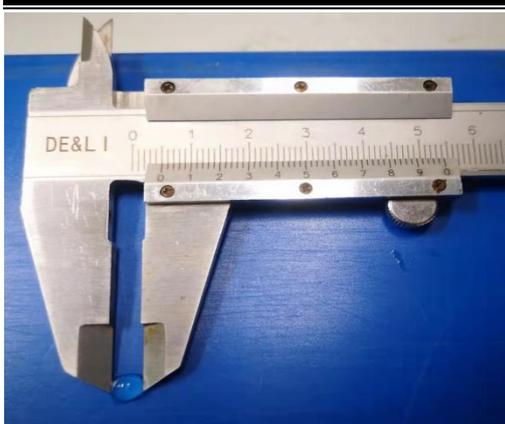
图 B-7 信鸽晶状体直径测量
