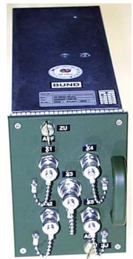
Auch LwL-Module mit Komponenten nach TL 6020, außen mit LwL-Linsenstecker Typ 2 der EUROCOM Basic Parameters D/1, innen mit LwL-Linsenstecker im Gehäuse VG 96 912 oder MIL-C-38999 sowie handelsüblichen LwL-Steckern (z.B. F-SMA, ST, SC, FC/PC usw.) sind durch uns lieferbar. Aber auch Module mit elektr./opt. Wandlern gehören zu unserem Lieferspektrum.
