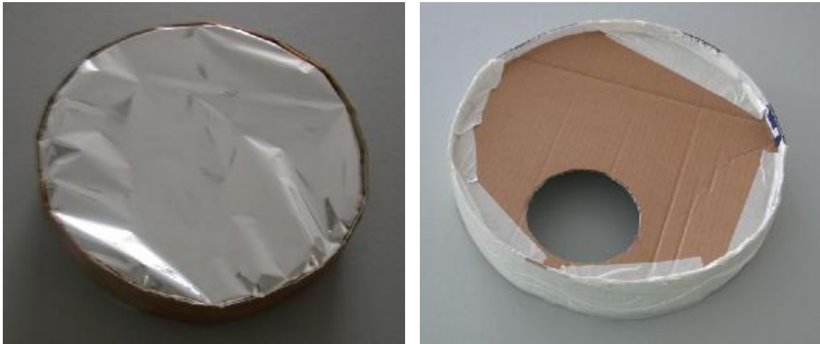
Filtro doble Mylar (izquierda) y diafragma (derecha) utilizados con el telescopio.
