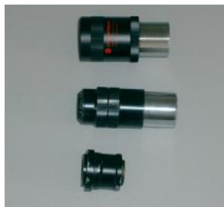
Oculares utilizados con el telescopio. De arriba hacia abajo: 30, 40 y 10 mm de focal.
