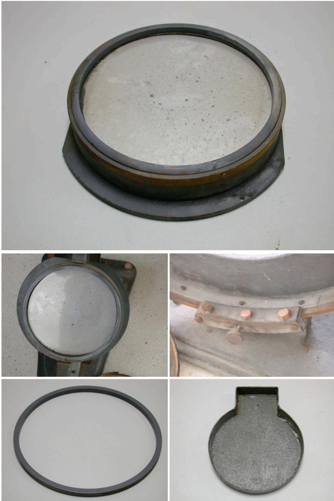
**Figura 11.** *Extremo Superior:* Aspecto de la celda del espejo primario después de un día de aplicarle refresco de cola a los tornillos. *Arriba Izquierda:* Celda del espejo primario. *Arriba Derecha:* Detalle del sistema de latitud del primario. *Abajo Izquierda:* Aro de hierro de sujeción del espejo secundario en su celda. *Abajo Derecha:* Tapadera del engranaje de altura del secundario.
