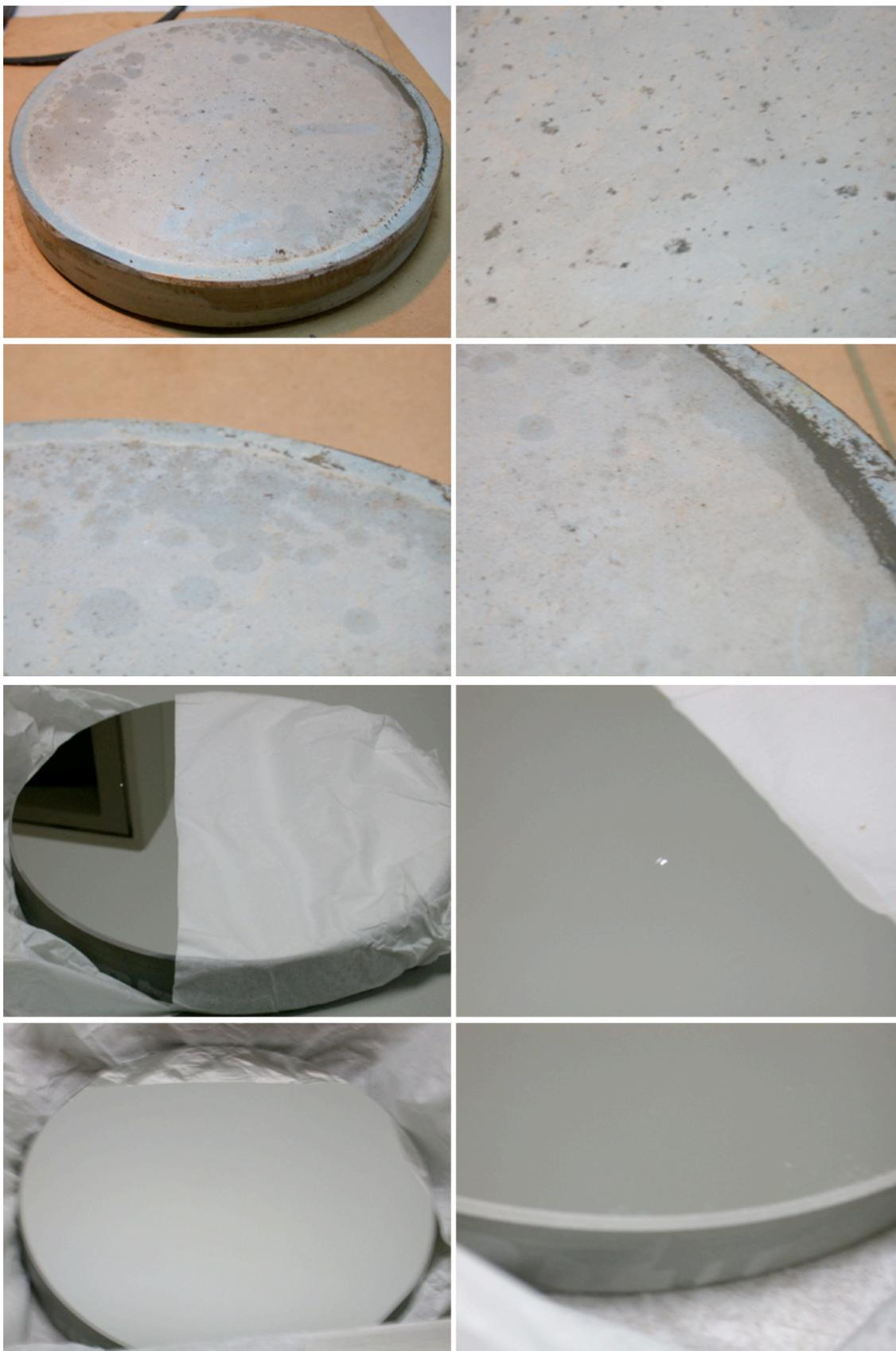
**Figura 23.** 4 Fotos Superiores: Espejo primario antes de ser limpiado y aluminizado. 4 Fotos Inferiores: Espejo primario realuminizado. La diferencia es abismal. No obstante, se aprecia una pequeña mella en el espejo. esperamos que dicha mella no interfiera demasiado con la resolución del espectrógrafo encargado de recoger la imagen.
