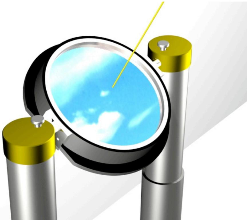
**Figura 50.** Vista tridimensional informatizada de la celda del espejo secundario, instalada en su torre, realizada por José Luis Corral. Los tornillos que ajustan la celda requieren la inclusión de dos piñones perpendiculares que harán que la anchura global del montaje aumente unos pocos *cm*.
