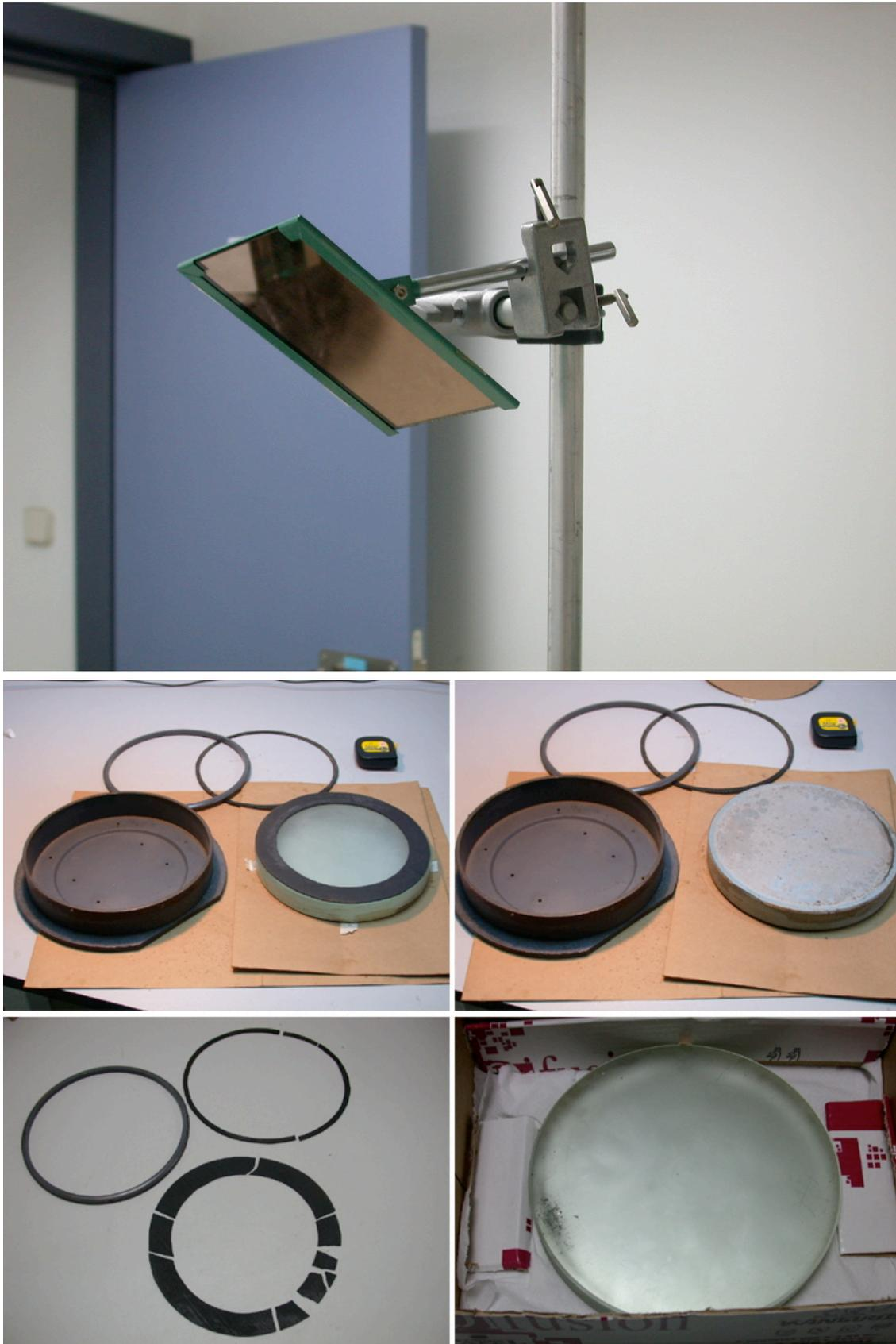
**Figura 21.** *Extremo Superior:* Maqueta de la torre del espejo secundario. *Arriba Izquierda:* Espejo primario y su celda recién desacoplados. *Arriba Derecha:* El espejo ha sido dado la vuelta para que se vea la cara especular. *Abajo Izquierda:* Aros de hierro y goma del montaje. *Abajo Derecha:* Espejo primario embalado.
