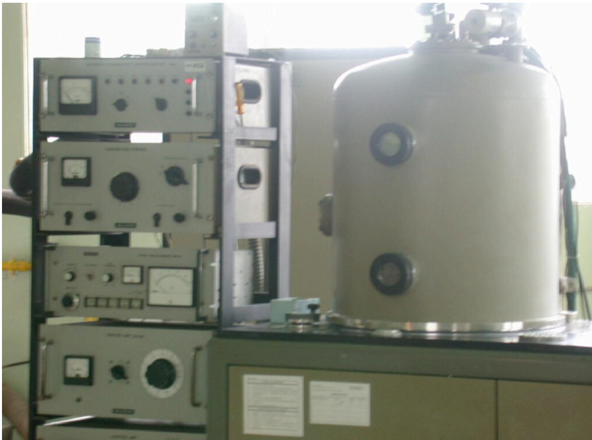
**Figura 22.** Campana de aluminizado de espejos en BOBES, el Molar.
