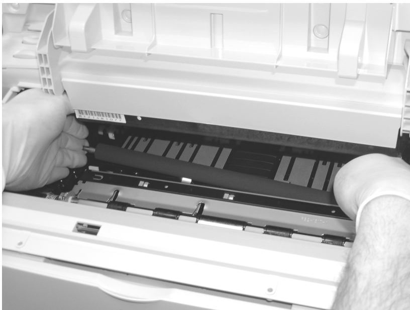
Abbildung 4 Entfernen der Transferwalze
