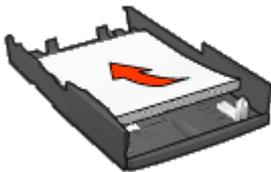
4. Schieben Sie das untere Fach in die Führung hinein, bis es einrastet.
