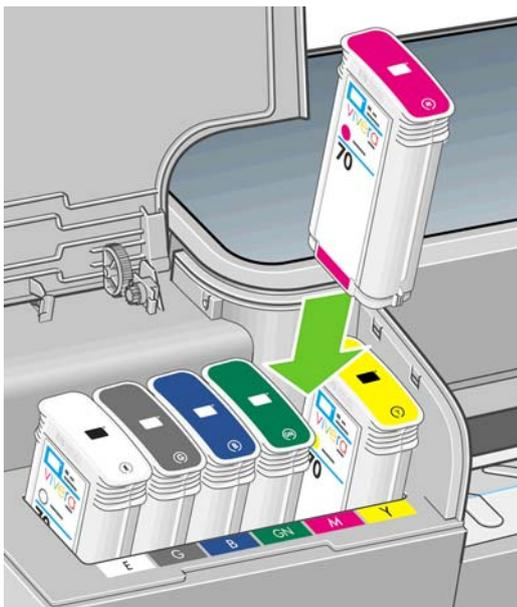
4. Drücken Sie die Patrone in den Schacht, bis sie einrastet. Sie müssen einen Signalton hören und auf dem Bedienfeld die Bestätigung sehen, dass die Patrone eingesetzt ist.
