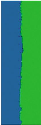
Bei hoher Luftfeuchtigkeit kann das Papier von Tinte durchtränkt sein, sodass die Konturen verwischt werden. Führen Sie die folgenden Schritte aus:
