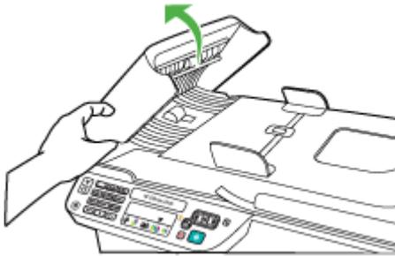
3. Heben Sie die Abdeckung des automatischen Vorlageneinzugs bis in vertikale Position an.
