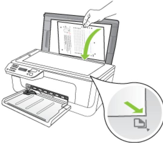
4. Drücken Sie **OK**, um die Ausrichtungsseite zu scannen. Die Ausrichtung ist nach dem Scannen der Ausrichtungsseite abgeschlossen. Entsorgen Sie die Ausrichtungsseite.
