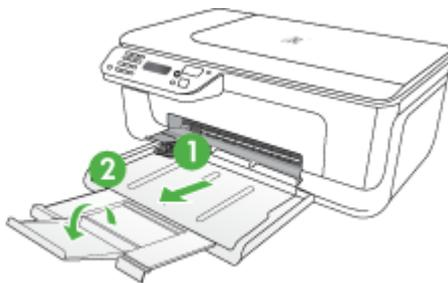
2. Legen Sie die Druckmedien mit der zu bedruckenden Seite nach unten entlang der rechten Seite des Hauptfaches ein. Achten Sie darauf, dass der Medienstapel rechts und hinten am Fach anliegt und nicht über die Begrenzungslinie im Fach herausragt.
