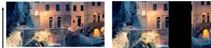
Vorlage und von ausgefallenem CIS-Modul betroffener Scan
