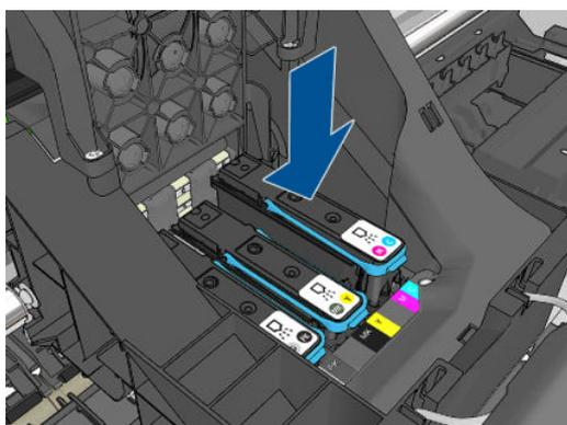
**⚠ ACHTUNG:** Beim Einsetzen eines neuen Druckkopfs ist ein gewisser Widerstand spürbar. Sie müssen daher fest, aber gleichmäßig drücken. Wenn der Druckkopf richtig eingesetzt ist, hören Sie einen Signalton, und auf dem Bedienfeld wird eine Bestätigung angezeigt. Falls Probleme auftreten, lesen Sie den Abschnitt [Einsetzen eines Druckkopfs nicht möglich auf Seite 171](#).
