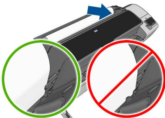
9. Schieben Sie den Rollenanfang in den Drucker, bis Sie einen Widerstand spüren und das Druckmaterial sich leicht biegt. Wenn der Drucker den Rollenanfang erkennt, zieht er ihn automatisch ein.
