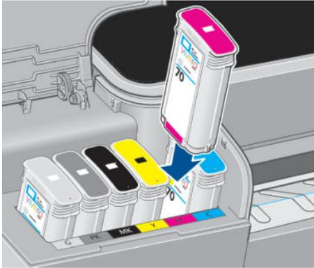
4. Drücken Sie die Tintenpatrone in den Schacht, bis sie einrastet. Sie müssen einen Signalton hören und auf dem Bedienfeld die Bestätigung sehen, dass die Patrone eingesetzt ist.
