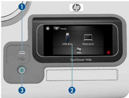
1. Ein High Speed USB-Hostanschluss zum Anschließen eines USB-Sticks, auf dem zu druckende Dateien zur Verfügung stehen können. Wenn ein USB-Stick eingesteckt wird, wird ein USB-Symbol
