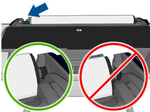
6. Drücken Sie die Spindel mit beiden Händen gleichzeitig in die Rollenhalterungen.
