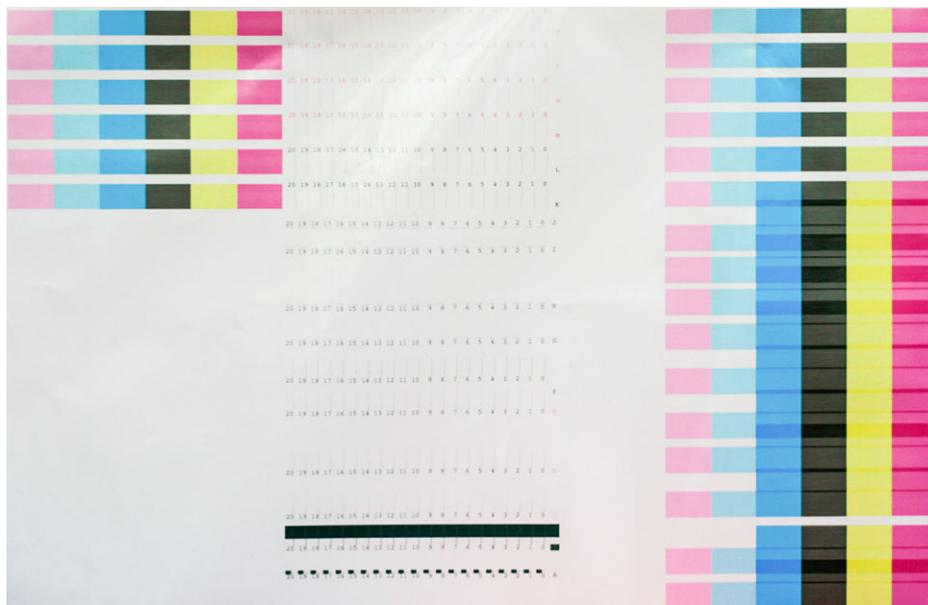
Der Drucker druckt nun 16 Zeilen, die von A bis P beschriftet sind. Überprüfen Sie den Druck, und notieren Sie die Nummer der geradesten Linie in jeder Zeile (z. B. A:9).
