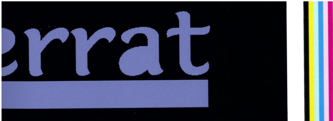
3. Fügen Sie vor dem Drucken von Hand seitliche Farbbalken zum Bild hinzu. In diesem Fall können Sie entweder die Standardfarben oder eine bestimmte Farbe verwenden, bei der das Problem auftritt. Jeder Farbbalken sollte 3 mm breit sein.
