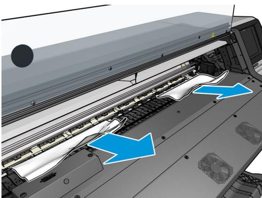
**⚠ ACHTUNG:** Ziehen Sie das Druckmaterial möglichst nicht durch den Zufuhrpfad, weil die normale Bewegungsrichtung dadurch umgekehrt wird. Dies könnte zu Schäden an den Druckerkomponenten führen.
