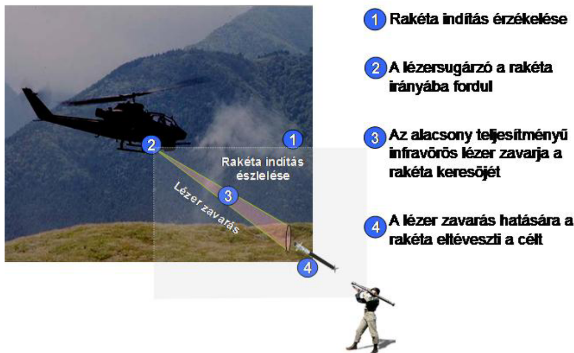
7. számú ábra Lézeres infravörös zavaró rendszer működési elve
