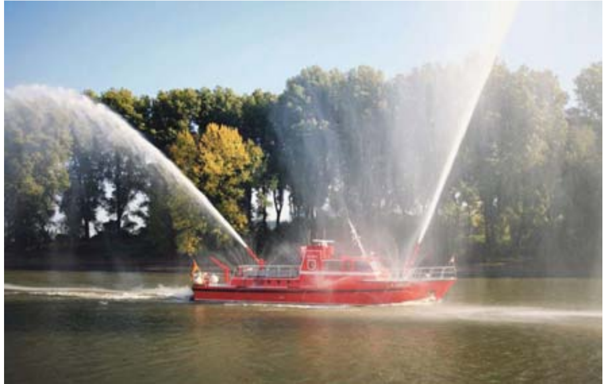
Im Bedarfsfall kann das Löschboot bis zu 6.000 Liter Löschmittel einsetzen – pro Minute.
