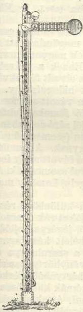
1. ábra. Egykarú szemafor tilos állásban.
