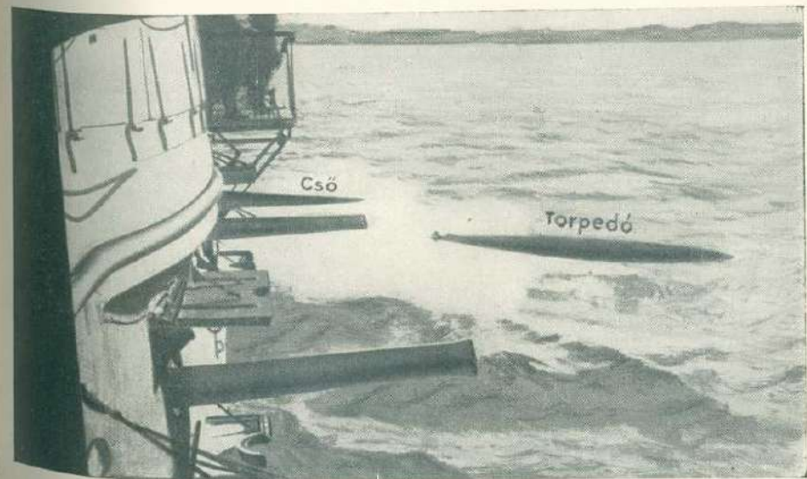
11. ábra. Torpedó kilövése vízfeletti csőből.
