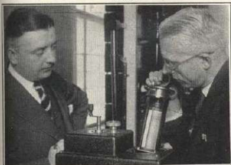
A Berlin-New York közti közvetlen képtávítás adója. Az adócsőben az összegyöngyölt kép
