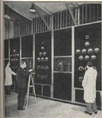
Hangosfilm leadója Baird rendszere szerint. A 10 KW magasfeszültségű ultrarövidhullámú (7,0 m) rádió adója London és környéke számára
