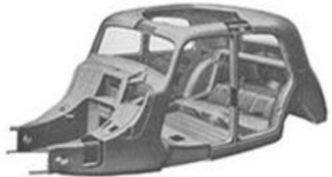
Fig.3. Citroen Traction Avant Body-Chassis Unit(1935)
