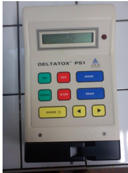
Εικόνα 6 – Αναλυτής Deltatox για τη δοκιμή τοξικότητας με το Vibrio fischeri .
