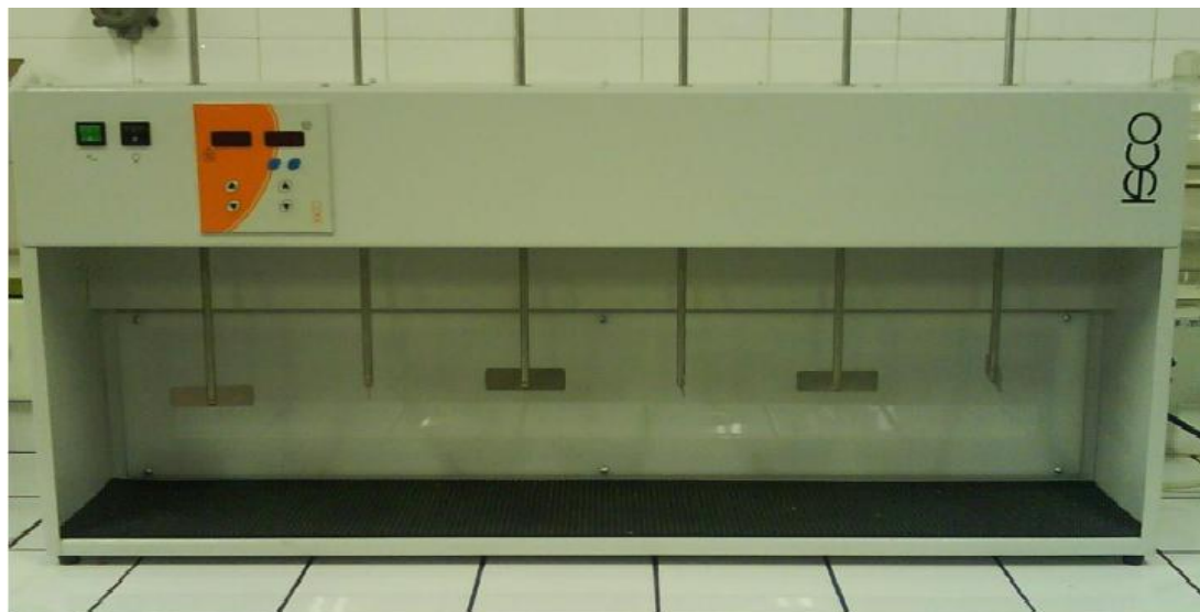
Εικόνα 4 - Συσκευή δοκιμών κροκίδωσης jar test.
