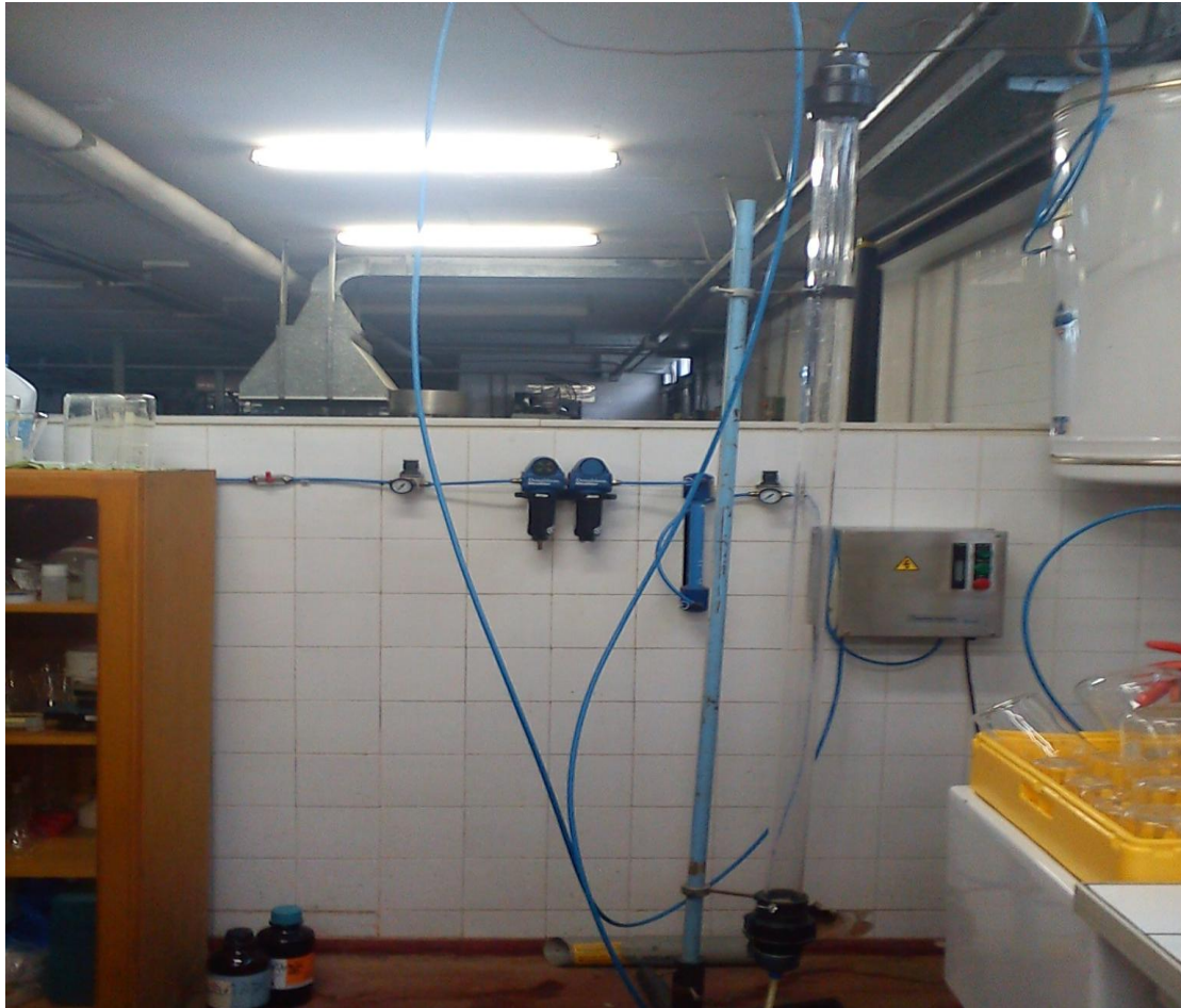
Εικόνα 5 - Εργαστηριακός αντιδραστήρας για τη διεργασία των πειραμάτων οζονισμού.
