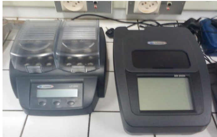
Εικόνα 5 – Θερμοαντιδραστήρας και φασματοφωτόμετρο για την μέτρηση του COD.
