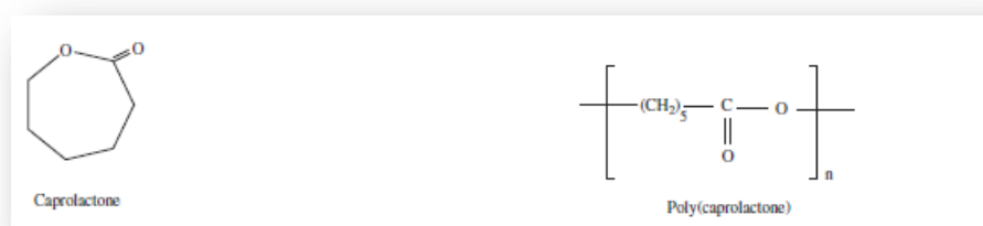
Σχήμα 2.4 Η δομή της πολυκαπρολακτόνης
