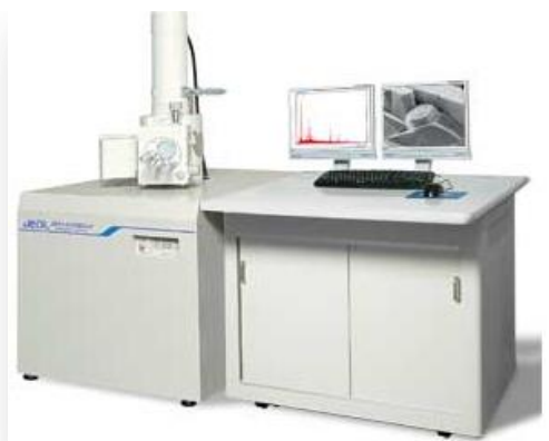
Σχήμα 7.2 Σύστημα Ηλεκτρονικής Μικροσκοπίας Σάρωσης (SEM), του τμήματος Φυσικής, με το οποίο μελετήθηκε η μορφολογία των δειγμάτων.
