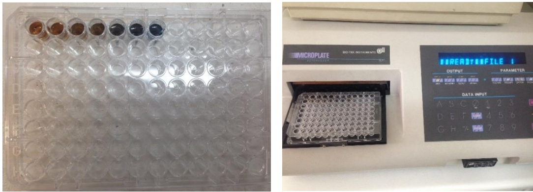
Εικόνα 10. α (αριστερά) Κατασκευή πρότυπης καμπύλης για υπολογισμό συγκέντρωσης άγνωστης πρωτεΐνης σε τρυβλίο 96 σπών, β (δεξιά) φωτόμετρο ELISA
