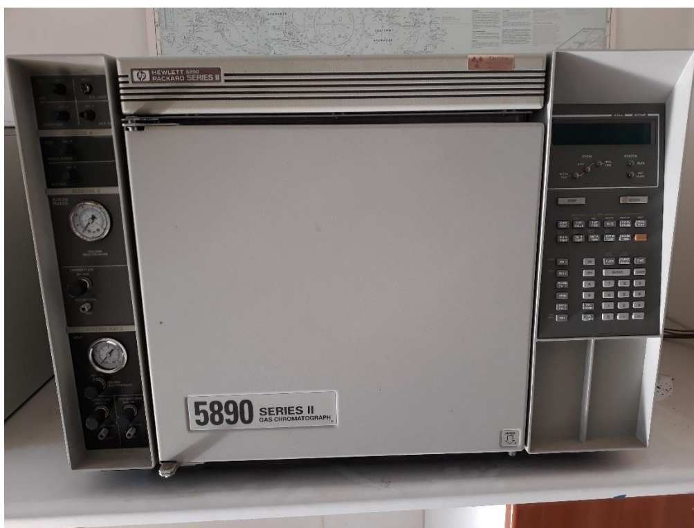
Εικόνα 2.9. Ο αέριος χρωματογράφος που χρησιμοποιήθηκε για την ανάλυση των λιπαρών οξέων.
