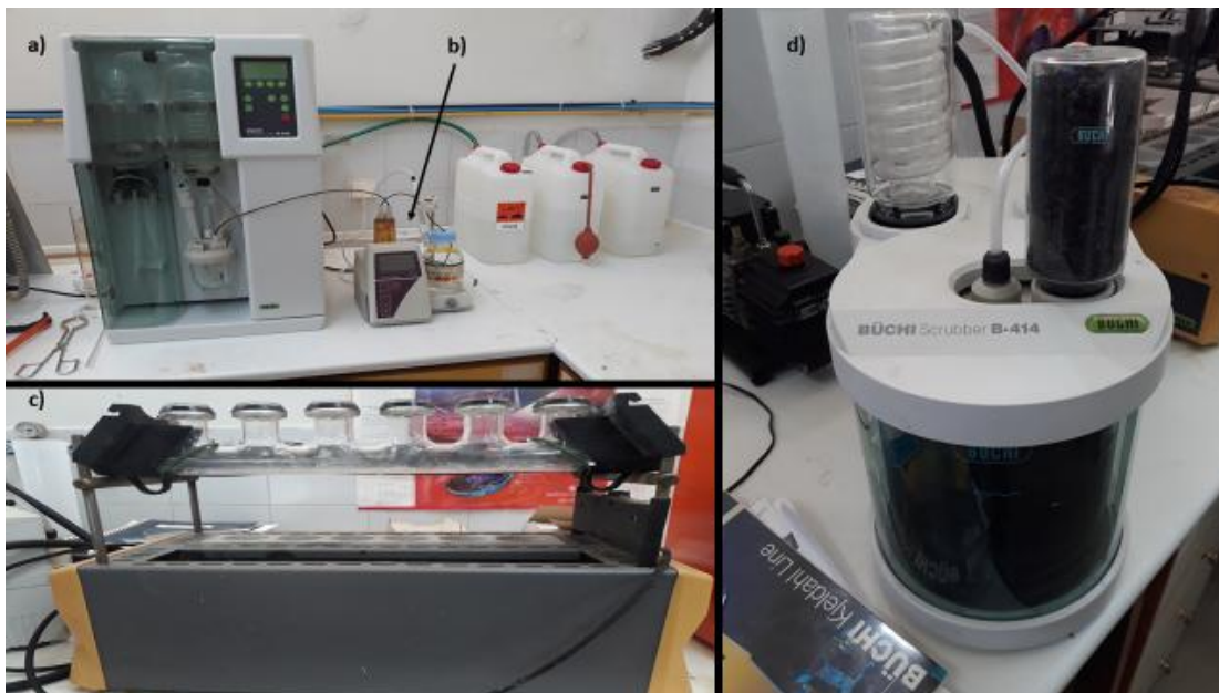
Εικόνα 2.12. Τα επιμέρους στοιχεία της συσκευής Kjeldahl. a) Distillation Unit B-324, b) TitroLine 96, c) Digestion Unit K-424, d) Scrubber
