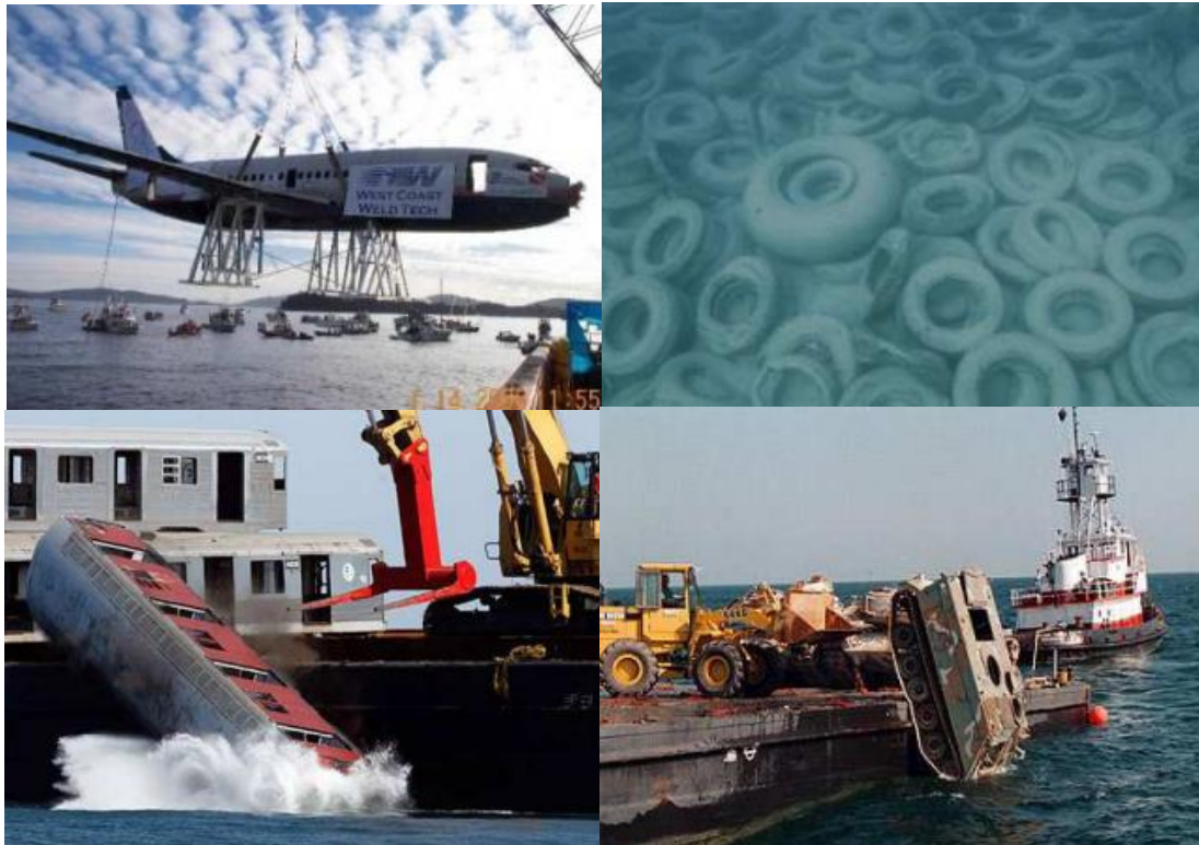
Εικόνα 5: Υλικά που έχουν χρησιμοποιηθεί για την δημιουργία και πόντιση τεχνητών υφάλων. (πηγή: www.dnr.sc.gov )
