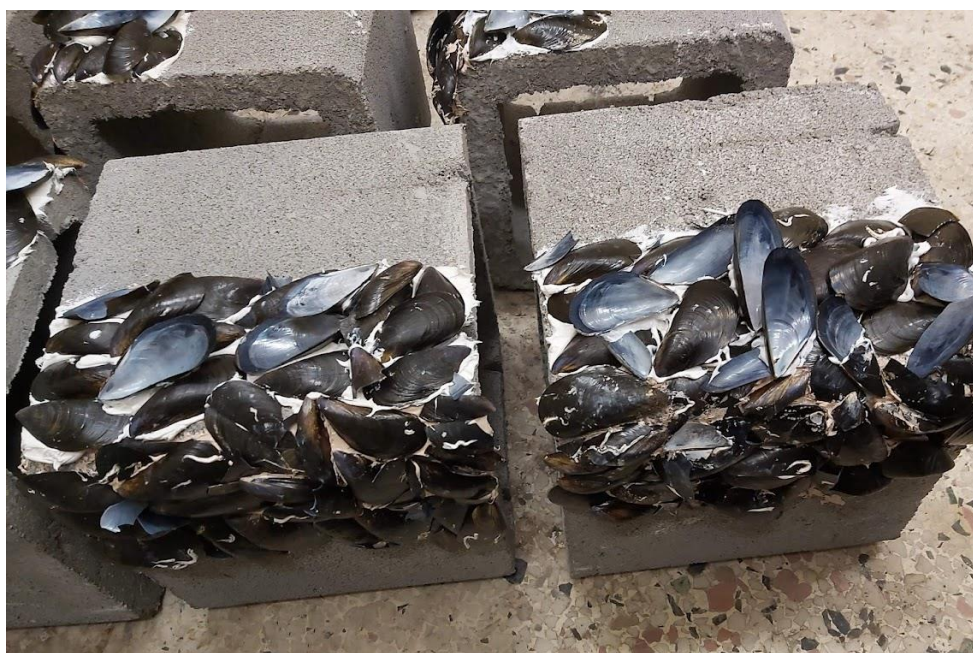
Εικόνα 11 : Ολοκληρωμένες κατασκευές τεχνητών υφάλων.
