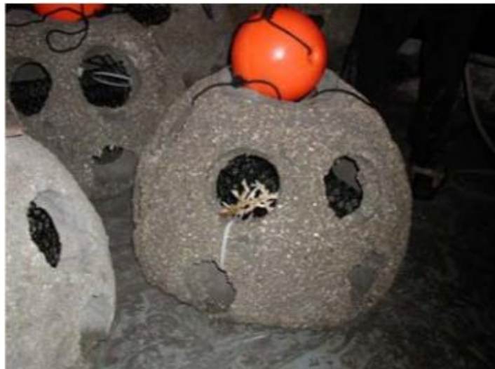
Εικόνα 3: Σφαιρική κατασκευή από σκυρόδεμα με ενσωματωμένο κοράλλι του γένους Oculina , για αποκατάσταση κοραλλιογενών βιοκοινωνιών στην Φλόριντα. (Εικόνα από Koenig 2001)
