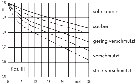
Leuchten mit direkter/indirekter Lichtverteilung (Indirektanteil < 15 %) ohne Abdeckung und ohne Optik
