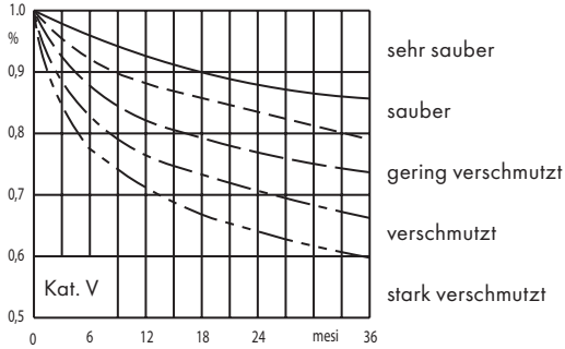
Leuchten mit teildirekter oder direkter Lichtverteilung mit Abdeckung (Methacrylat, Glas, Polycarbonat)
