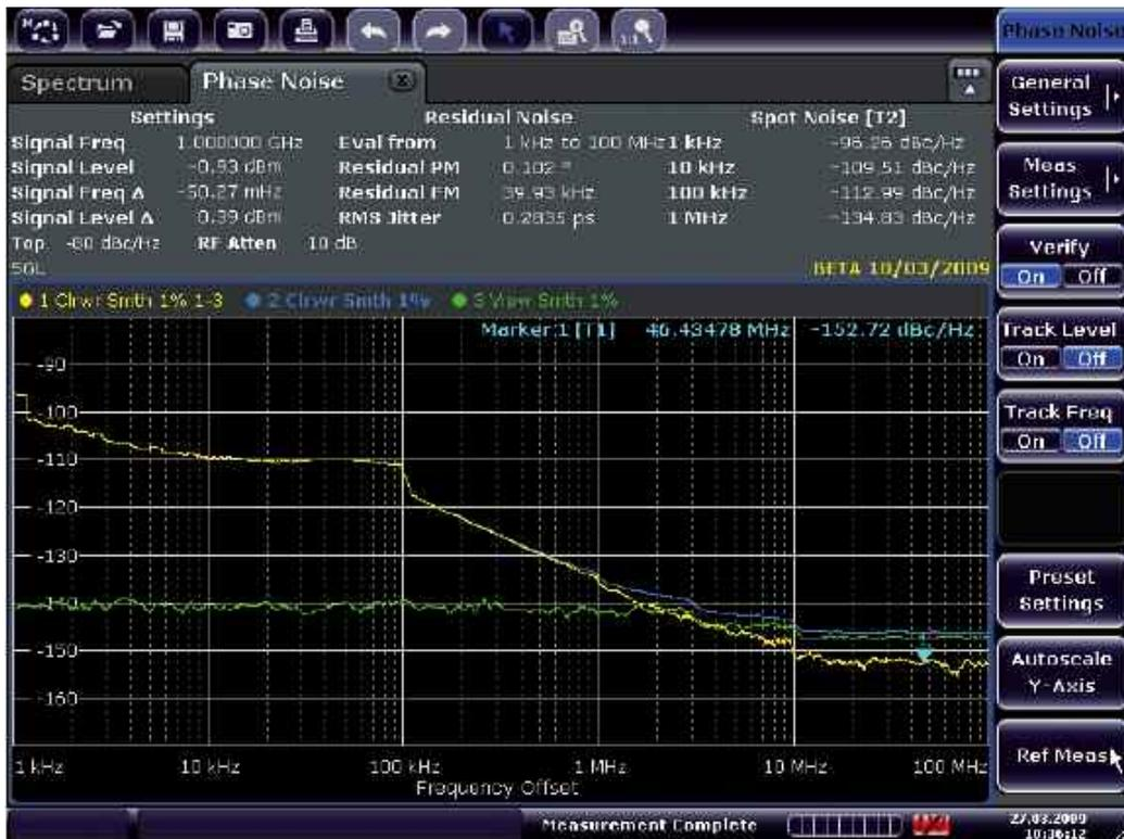
图 11: 用 R&S FSV 进行相噪测试——测试结果
