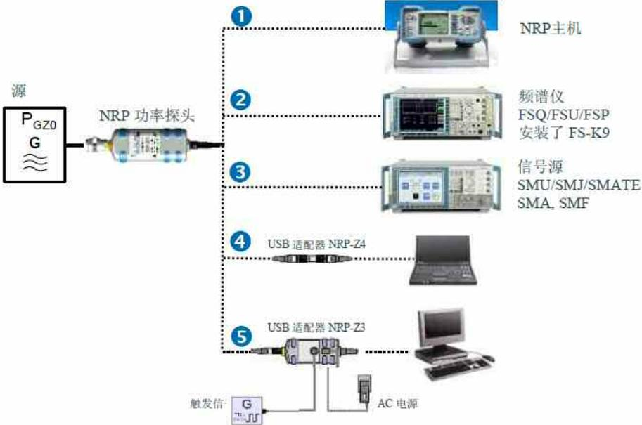
图 15: NRP 功率计的多种操作模式
