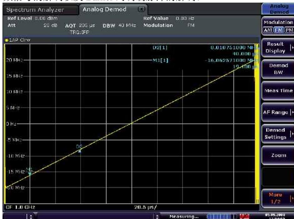
图 8：R&S FSV + FS-K7 选件进行线性调频信号的解调
