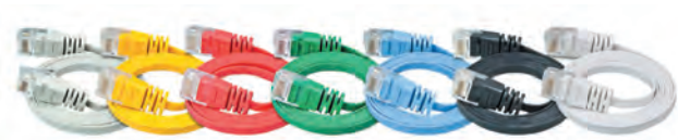
Slimpatch-Kabel UTP, Cat.6, AWG36, 1 Gbps, 100 % Kupfer, das wahrscheinlich dünnste Gigabit-Kabel der Welt, 6x dünner als handelsübliche Kabel, PoE-tauglich bis 10 Meter
