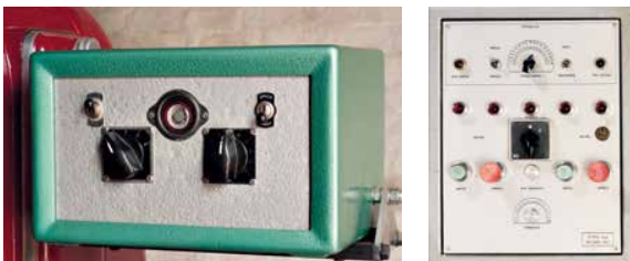
In alto: Dispositivo di controllo con sensore sulla Nuova Fima B200, 1966 In basso: Quadri di controllo fotocellule sulla G.D 2250 (a sinistra) e sulla Nuova Fima B200 Museo del Patrimonio Industriale, Archivio fotografico
