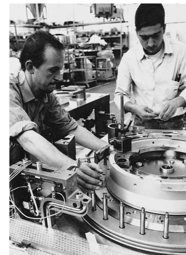
Particolare del sistema di incarto delle saponette sulla Carle & Montanari CMV 33, anni '70
