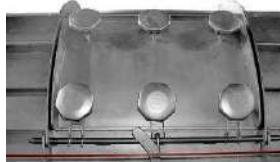
Tapas para abertura (PST 5 - 16) y puerta hermética (PST 21 - 55) en conjunto con las tapas para los canales permiten la maceración de la pasta y el mezclado mediante la rotación del tambor.
