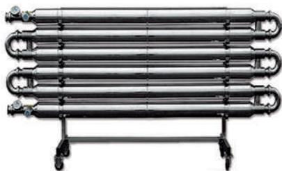
Intercambiadores a medida, formados por dos tubos de acero Inox, donde el intercambio térmico se produce a contracorriente entre el producto (que circula por el tubo interior) y el fluido refrigerante (que circula por el tubo exterior).
