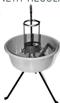
Limpieza con sistema de entrada de agua a través de MANETA Y GRIFO DE REGULACIÓN en cubeta.
