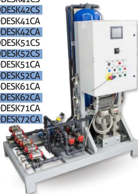
**KALIUM TEST:** es un sistema rápido de análisis que permite al enólogo de determinar con seguridad el tipo óptimo de intervención con intercambio iónico para cada vino.
