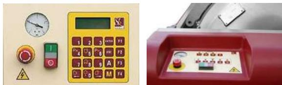
El automatismo AE permite operar de modo manual ó automático. El modo automático consta de cinco programas en la PS5 y de múltiples en otros modelos de prensado estándar, tres programas secuenciales y uno de prensado de uva congelada Se pueden seleccionar parámetros del prensado durante el proceso.
