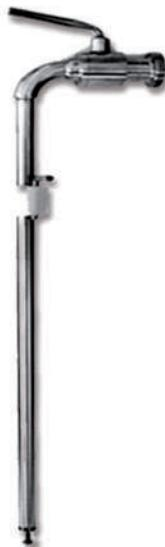
Caño vaciado de barricas, funciona acoplándolo a un surtidor de gas mezcla de carbónico y nitrógeno. Con este sistema el vino no entra en contacto con el oxígeno exterior.
