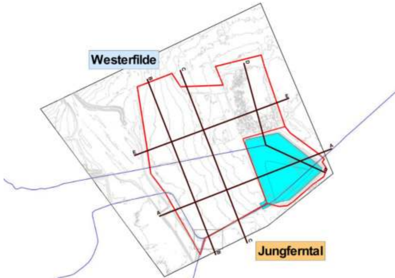
Abb. 12. Digitales Geländemodell der Stadt Dortmund (Minimale Höhe = 61,21 mNHN, Maximale Höhe = 86,21 mNHN) mit den maßgebenden Geländeschnitten (schwarze Linien)
