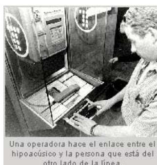
Figura 1.9. Sistema telefónico con teclado
