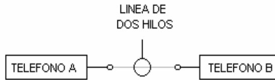
Figura 1.4. Conexión permanente entre dos teléfonos
