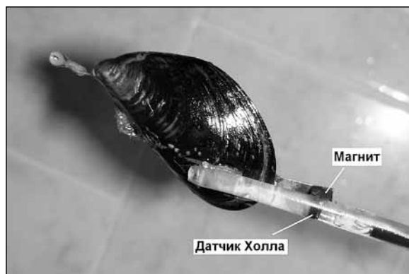
Рис. 1. Реальное положение датчика Холла и магнита на створках черноморской мидии при регистрации расстояния между створками
