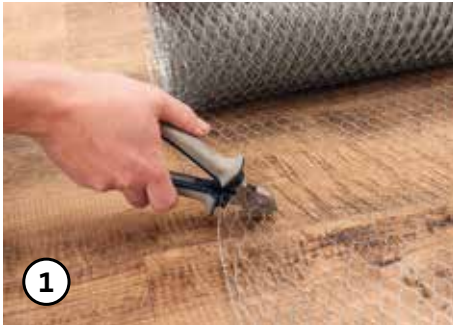
1 Sechskantgeflecht mit dem Seitenschneider zurechtschneiden.
