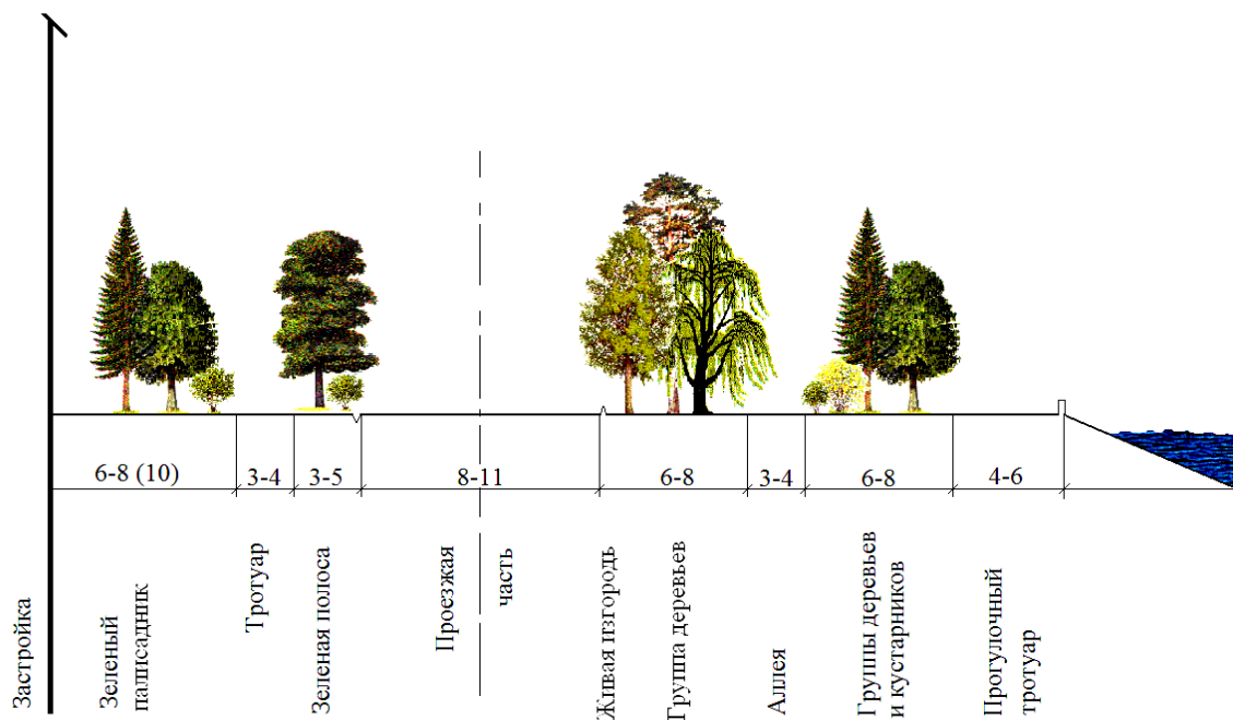
Рисунок 2 – Схема поперечного профиля бульвара набережной с проезжей частью для легкового автотранспорта
