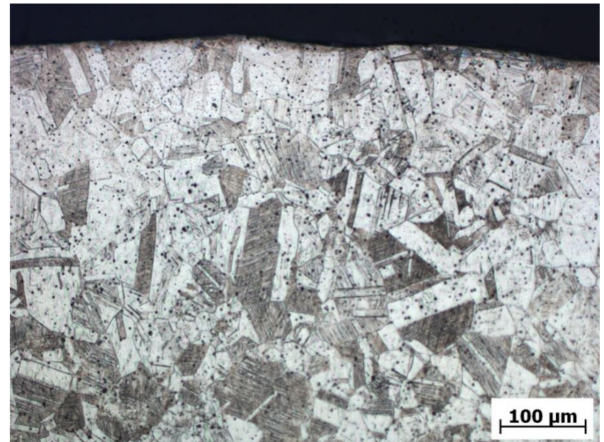
Obr. 13 Deformačné dvojčatá v mikroštruktúre AISI 316Ti, lept. elektrolyticky (Pavkov, 2011)
