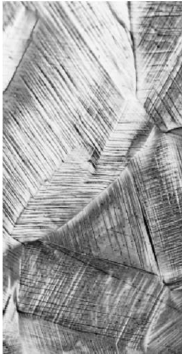
Obr. 7 Sklzové čiary na povrchu polykryštalickej medi (svetelná mikroskopia, (C. Brady – National Bureau of standards)
