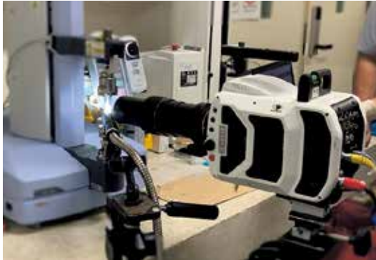
図1 微小引張接着試験機と超高速(UHS)ビデオグラフィのセッティング
