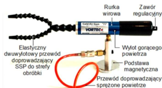
Rysunek 2. Elementy funkcjonalne dyszy CAG wykorzystywanej w badaniach procesu szlifowania, prowadzonych w Katedrze Inżynierii Produkcji Politechniki Koszalińskiej: dysza Vortec 610 [Kieraś, 2018]
