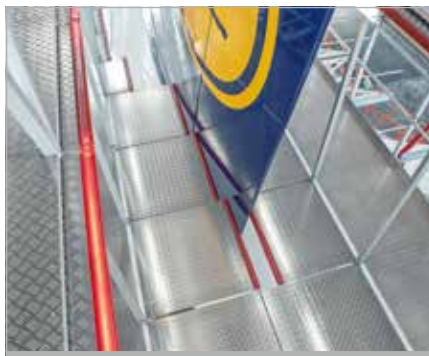
Ausschubsysteme mit Konturanpassung
