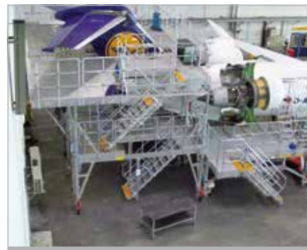
Dockanlage für Bombardier CRJ900
