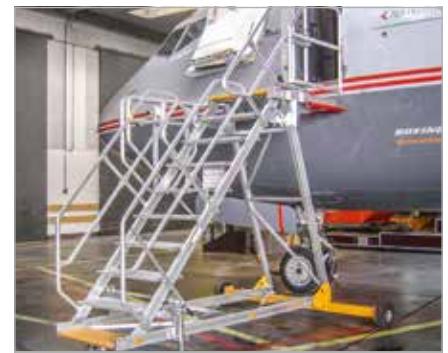
Wartungstreppe mit fester Höhe und breiterer Plattform
