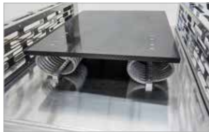
Aufnahmetisch, schwingend gelagert. Zur Auswahl stehen Gummipuffer oder Drahtseildämpfer.
