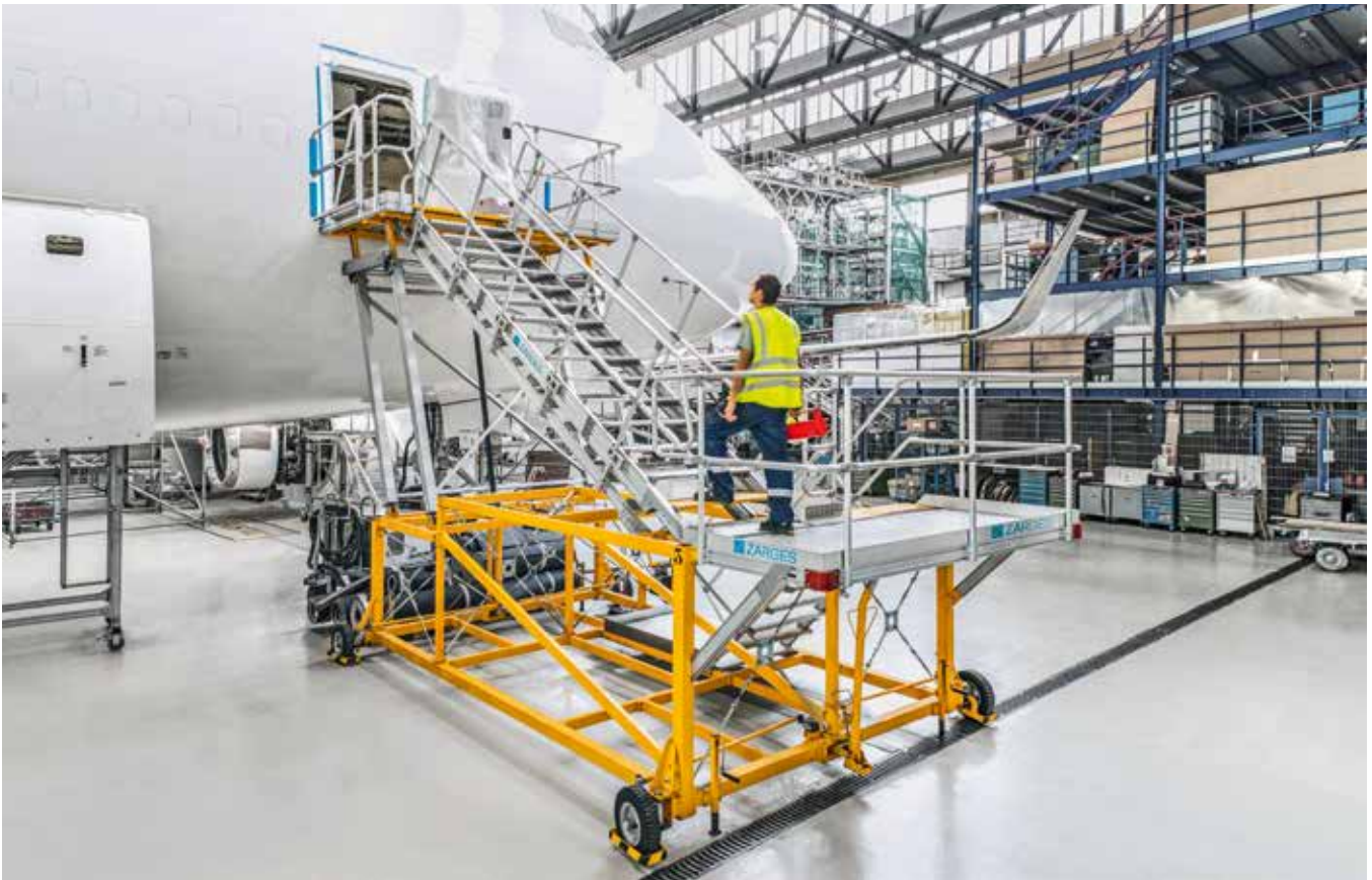
Wartungstreppe mit Zwischenplattform für Arbeiten am Passagiertürenzugang
