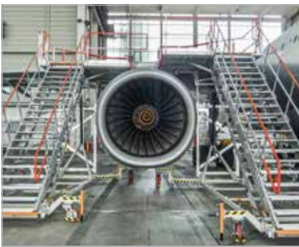
Fahrbare Wartungstreppe mit koppelbarer Auskragung
