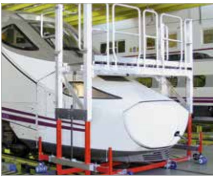
Höhenverstellbare Frontarbeitsbühne mit Schienenfahrwerk
