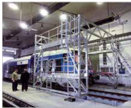
Portaldacharbeitsbühne, schienengeführt mit zwei Ebenen
