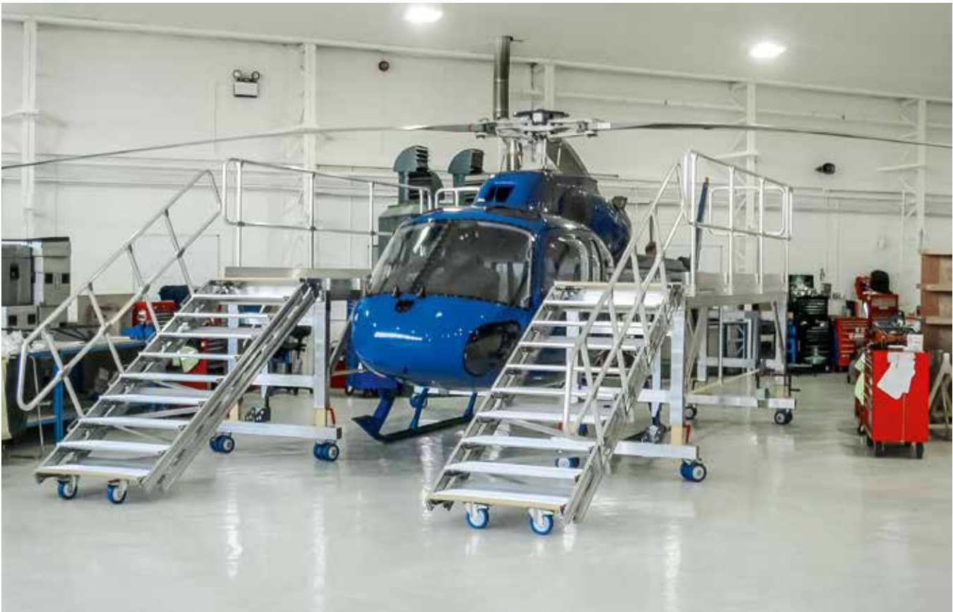
Höhenverstellbare Wartungsplattform für einen EC 145
