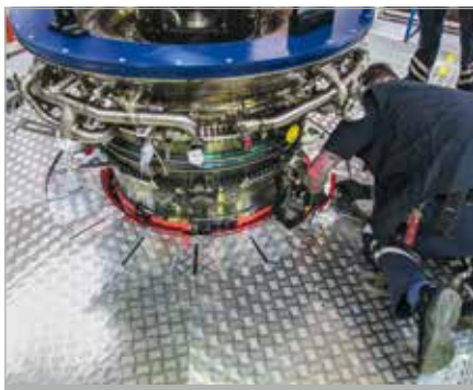
Wartungsbühne mit Ausschubsystem für Turbinenwartung
