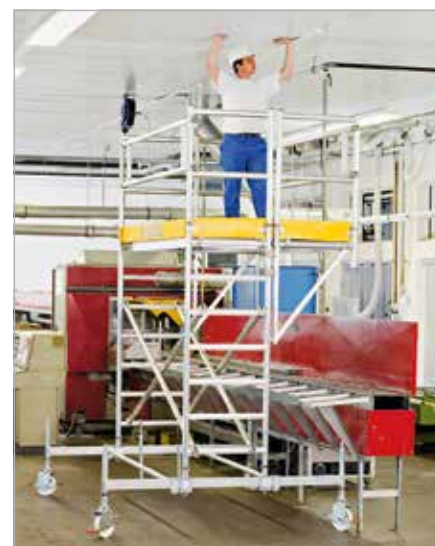
Konsolen können in drei Längen (1,80 m; 2,50 m und 3,00 m) an Fahrgerüste mit Fahrbalken bis zu einer Arbeitshöhe von 8,60 m angebaut werden.
