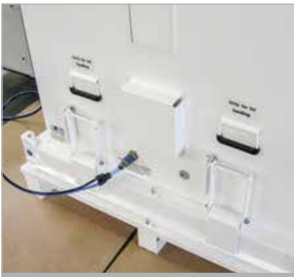
Wasserdampfdichter Behälter bei Dichtheitsprüfung durch Überdruck
