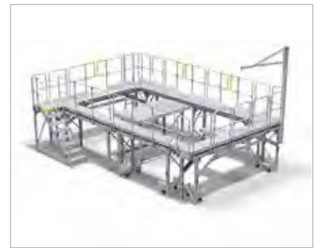
Fahrbarer Prüfstand mit Schiebekassetten und Lastkran
