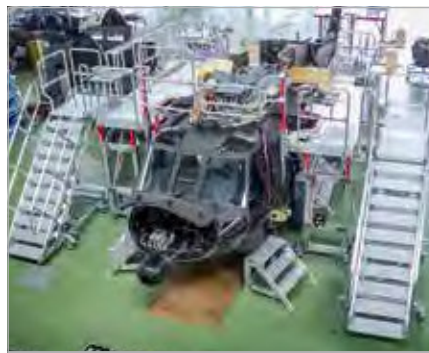
Vollständiges, in der Höhe anpassbares Docksystem für den S70
