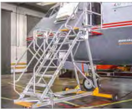
Sicherer Zugang zu Passagiertüren und Frachtluken
