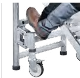
Zentralbremse durch Pedaltritt arretieren
