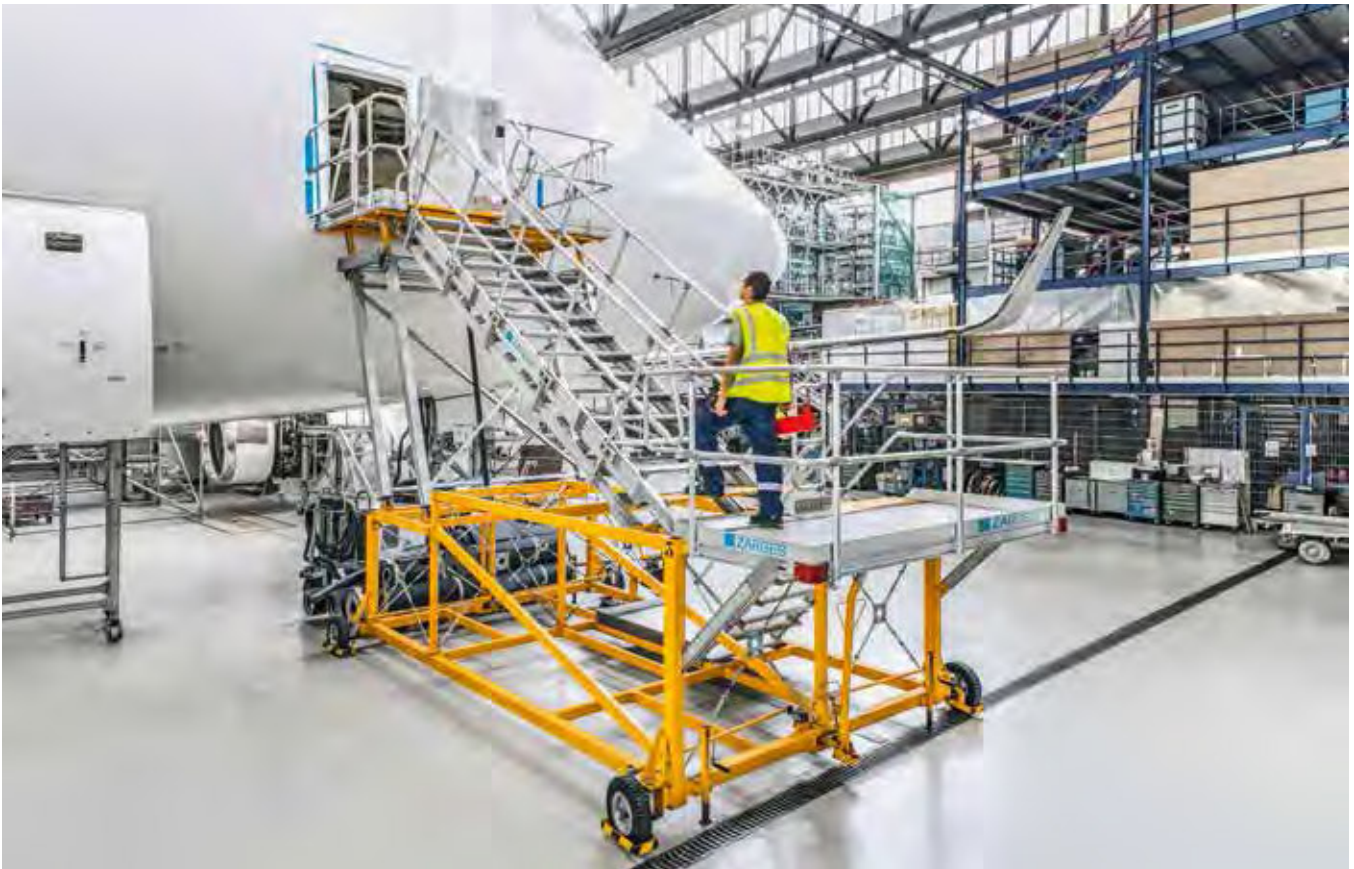
Wartungstreppe mit Zwischenplattform für Arbeiten am Passagiertürenzugang
