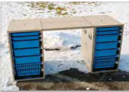
Zwei Container als Arbeitstisch einsetzbar, Tischplattenhälfte wird beim Transport im Deckel verstaut. Deckel kann auf der gegenüberliegenden Seite fixiert werden.
