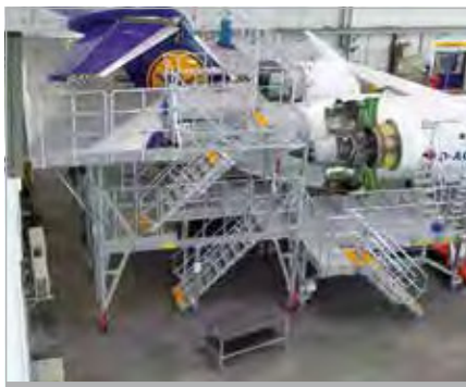
Höhenverstellbares Heck- und Triebwerksdock für eine CRJ900
