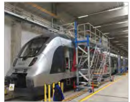
Einseitige Dacharbeitsbühne mit ausklappbarem Geländerkäfig zur Wartung eines Zugs der Abellio GmbH
