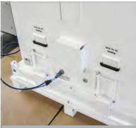
Wasserdampfdichter Behälter bei Dichtheitsprüfung durch Überdruck
