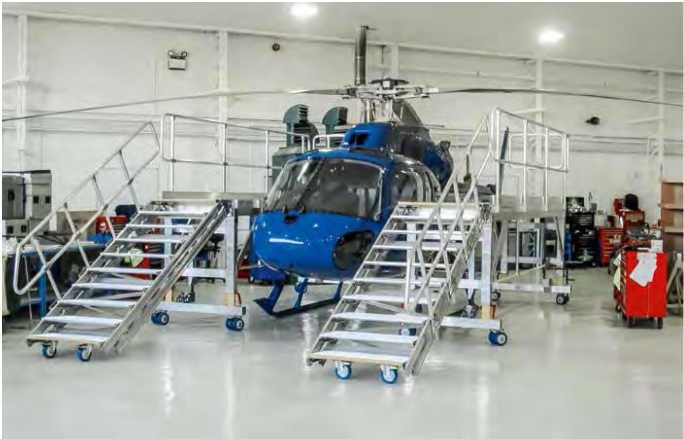
Höhenverstellbare Wartungsplattform für einen EC 145
