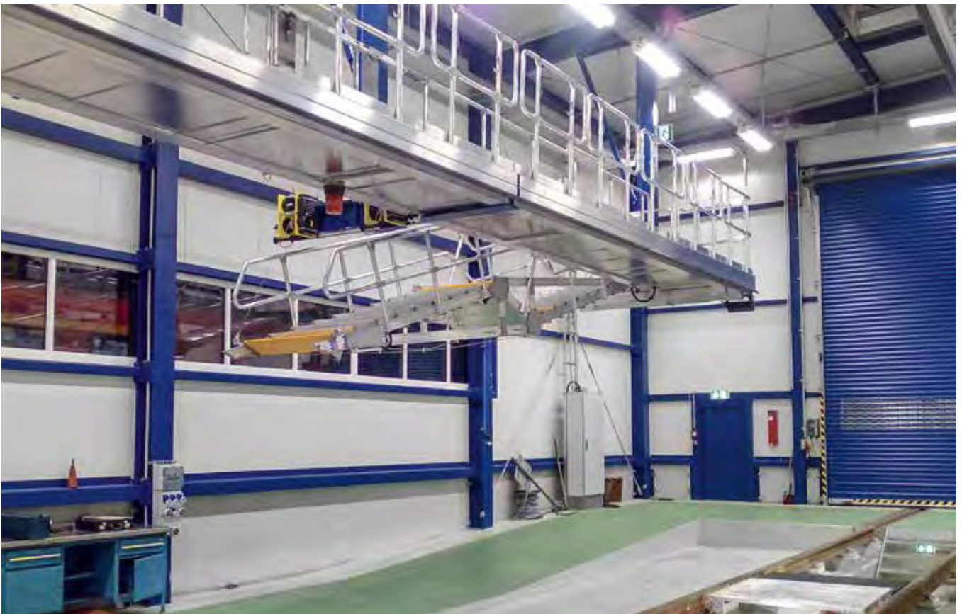
Schwenkbare Treppenlösung mit Zwischenpodest
