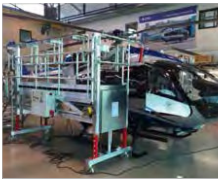
Wartungsbühne mit elektrischer Höhenverstellung
