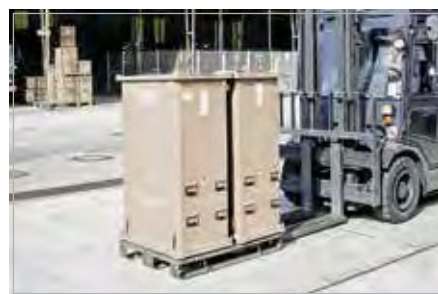
Palettenunterbau vereinfacht das Handling
