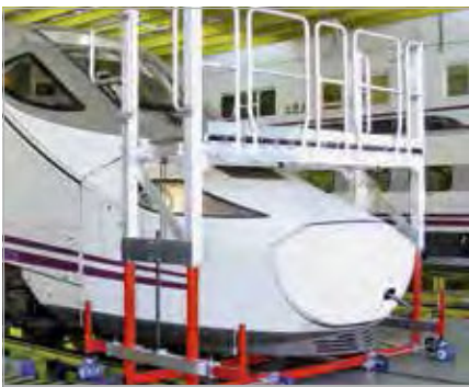
Höhenverstellbare Frontarbeitsbühne mit Schienenfahrwerk
