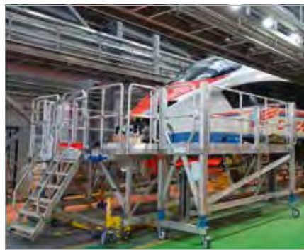
Modulares Arbeitsbühnensystem für Front- und Seitenzugang
