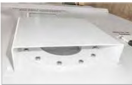
Sicherheitselement Berstscheibe: Schutz bei plötzlichem Druckabfall in der Umgebung. Kleinere Druckunterschiede werden durch ein Druckausgleichsventil ausgeglichen.
