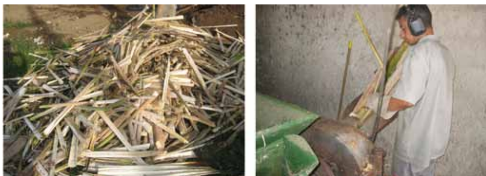
Figura 2 - Moagem visando à redução do tamanho dos diferentes materiais e aceleração no processo da compostagem.
