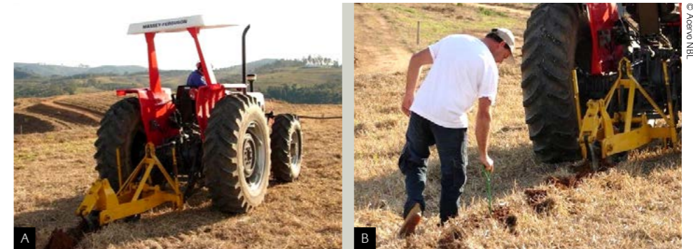
Figura 42: Área com o mato já seco, após aplicação de herbicida, sendo preparada para o plantio com um subsolador florestal (A) e técnico medindo a profundidade de subsolagem com uma haste de ferro (B).
