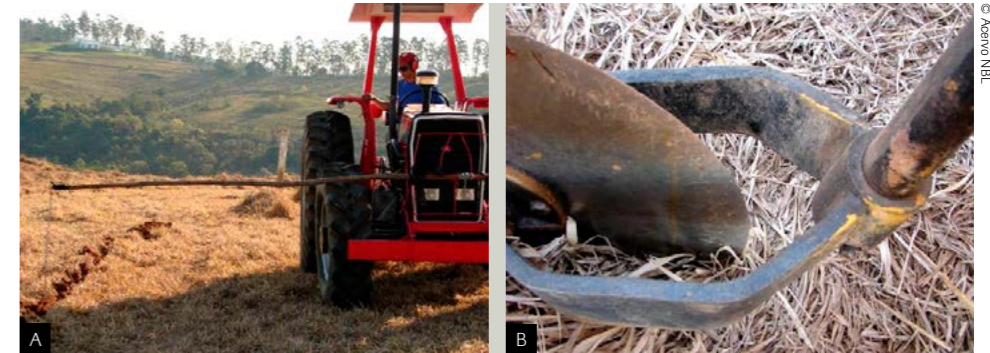
Figura 43: Uso de um pedaço de madeira com uma corrente em sua extremidade para a orientação da subsolagem em relação à linha adjacente (A) e disco de corte do subsolador cortando a palhada já seca (B).
