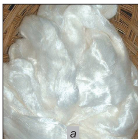
102. ábra Szintetikus szálak: a – viszkóz-szál; b – acetát-szál
