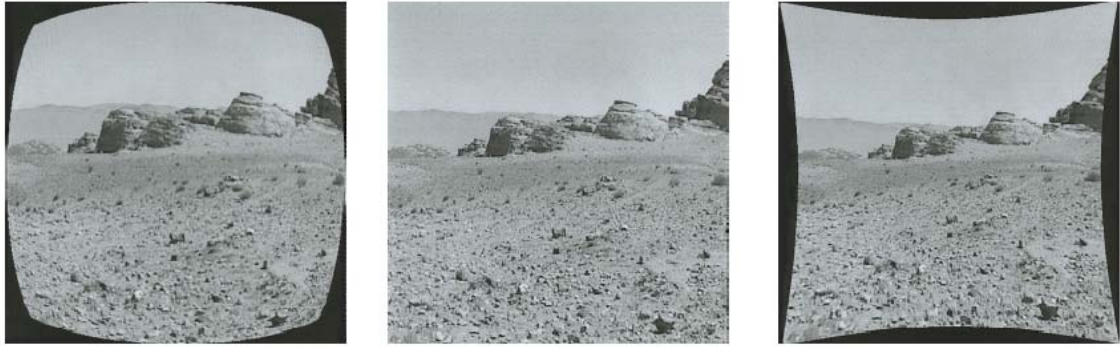
Kuva 11. Linssin aiheuttama linssivirhe vääristymä [34]
