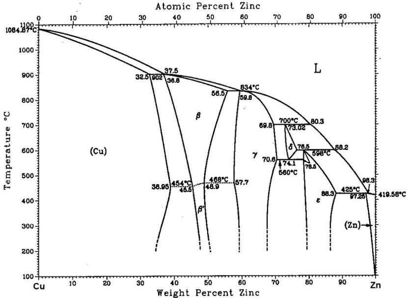
Figure 7. The Cu-Zn system.  $\alpha$ : 0 - 38.3 at.% Zn,  $\beta$ : 36.1 - 59.1 at.% Zn,  $\beta'$ : 44.7 - 48.2 at.% Zn,  $\gamma$ : 57 - 70.0 at.% Zn,  $\delta$ : 72.5 - 76.0 at.% Zn,  $\varepsilon$ : 78.0 - 88.0 at. % Zn,  $\eta$ : 97.2 - 100 at.% Zn [26].
