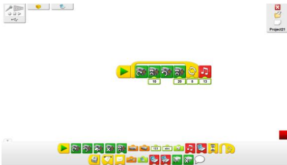
Slika 5. Uporaba zanke in nekaterih ukazov gibanja motorja v programskem okolju WeDo 1.0.
