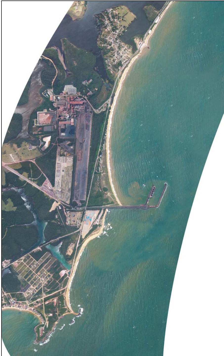
Figura 4.1.5.2.1-6: Imagem aérea do Terminal de Ubu evidenciando “manchas” de material ressuspensionado pela ação dos agentes hidrodinâmicos.
