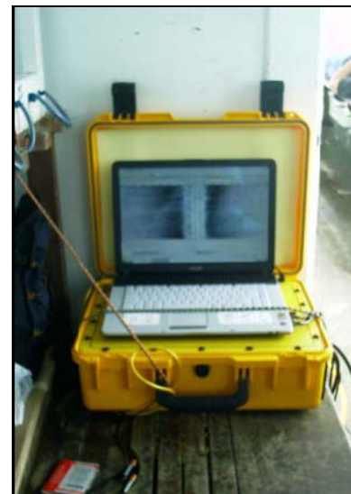
Figura 4.1.2.5-3: Foto do processador Edgetech 560P e do sistema de aquisição digital (laptop).
