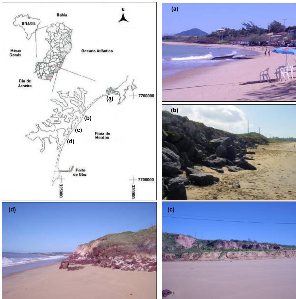
Figura 4.1.2.2.3-3: Arco Meaípe – Mãe-Bá com erosão de cordões e falésias vivas. Verificam-se enrocamentos (b) na tentativa de conter o processo erosivo. Fotos: Jacqueline Albino (CEPEMAR, 2007).
