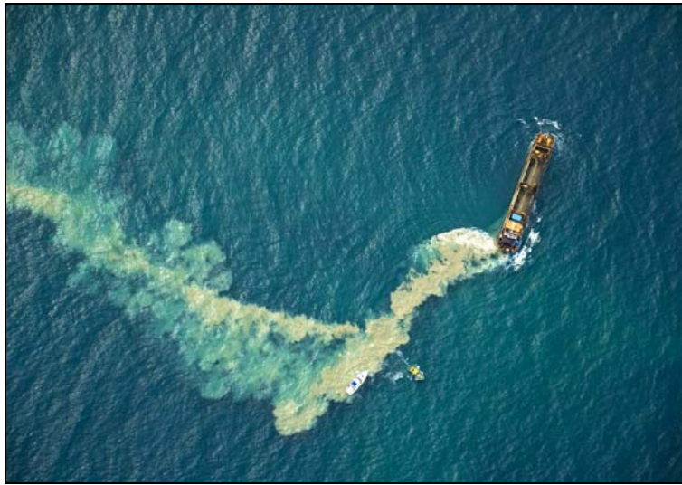
Figura 4.1.5.2.1-5a: Imagem aérea obtida pouco após o descarte de dragados durante experimento realizado no dia 20/10/2007. Fonte: CEPEMAR (2008e).
