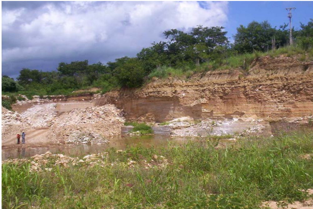
Foto 8.4 – Pedreira do André, afloramento 1, Pedra Branca, em Nova Olinda, com parte dos serviços paralisados por dificuldades climáticas (poças de água) e material quebrado e não aproveitável, entulhando a praça da frente de mineração (do autor).
