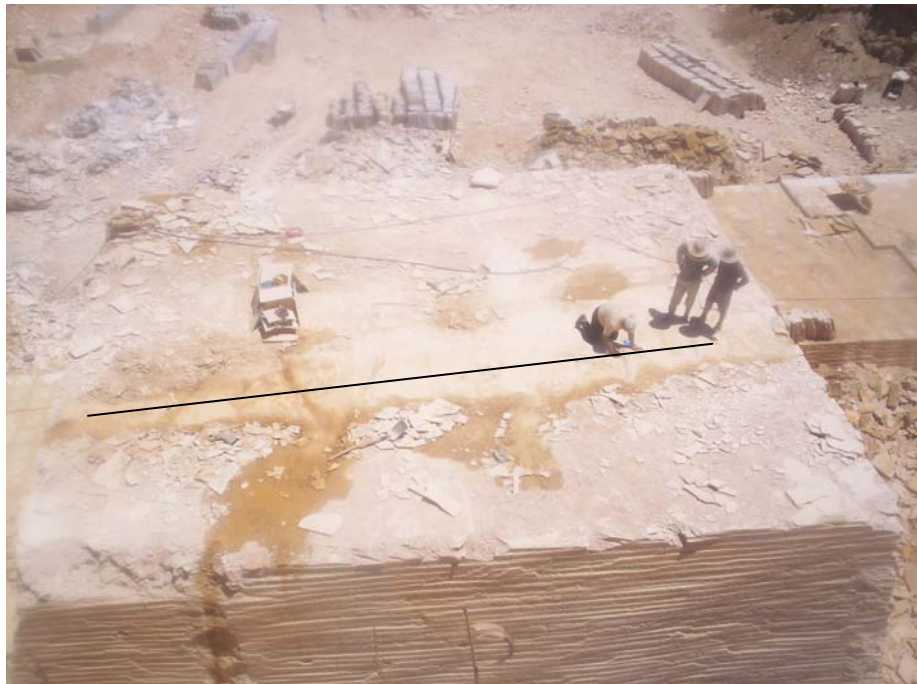
a) Área onde foram tomadas medidas do scanline de 10m na pedreira do Idemar.
