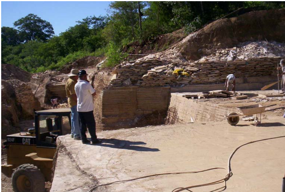
Foto 8.7 – Pedreira do Cantagalo, afloramento 5, em Santana do Cariri, com serviços dificultados pelo estreitamento da bancada e material quebrado e não aproveitável como proteção de estéril (do autor).
