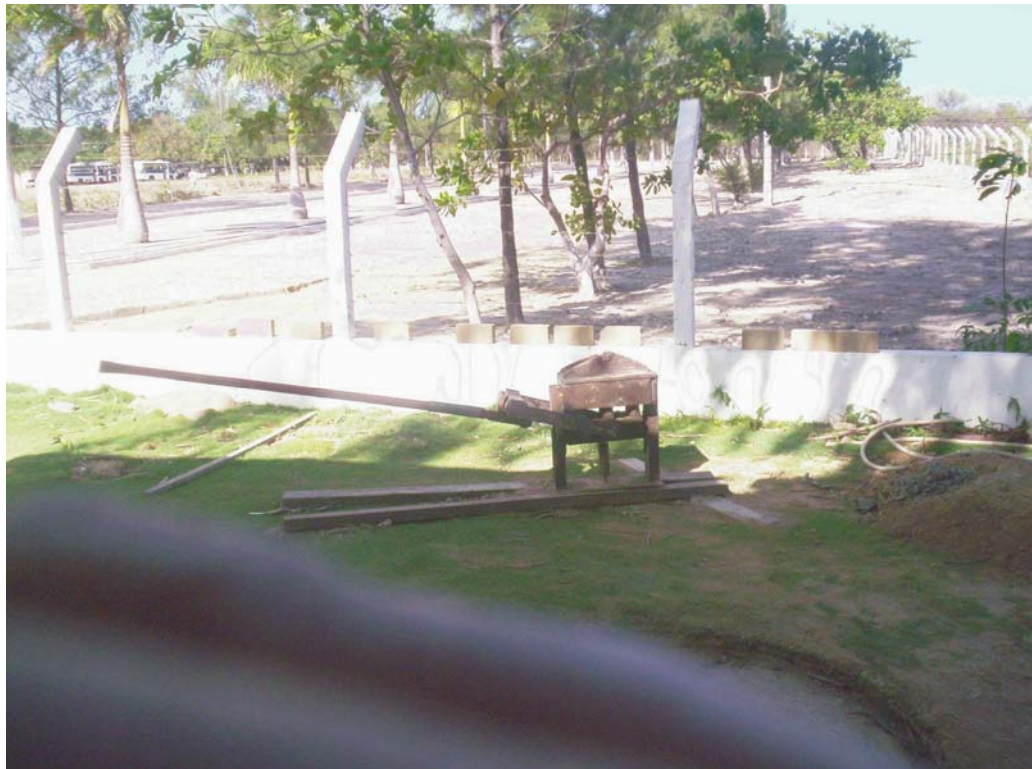
Foto 7.4 – Equipamento para produzir tijolos solo/cal do NUTEC, Fortaleza, usados na construção em 1985; ao fundo, encontram-se algumas unidades de tijolos secando ao sol, dispostos na mureta da cerca divisória da propriedade (do autor).
