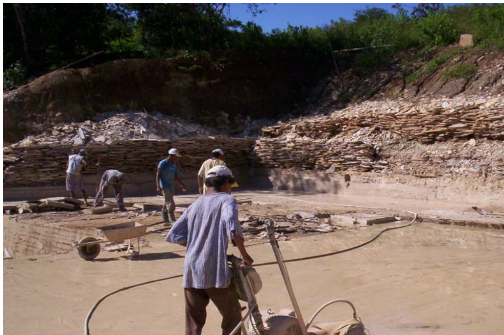
Foto 8.8 – Pedreira do Baixio do Mota, afloramento 6, em Santana do Cariri, com material quebrado jogado em cima da bancada a ser trabalhada, formando barricada de proteção do estéril (do autor).
