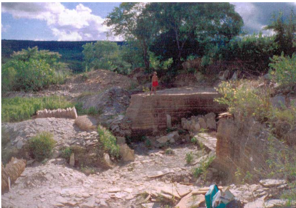
Foto 8.2 – Pedreira do Baixio do Zé Gomes, Santana do Cariri, com praticamente toda a área de trabalho e caminhos preenchida de entulho e placas (a maioria com dimensões irregulares) para serem cortadas e já descendo a encosta do riacho adjacente à pedreira (Oliveira, 1998).
