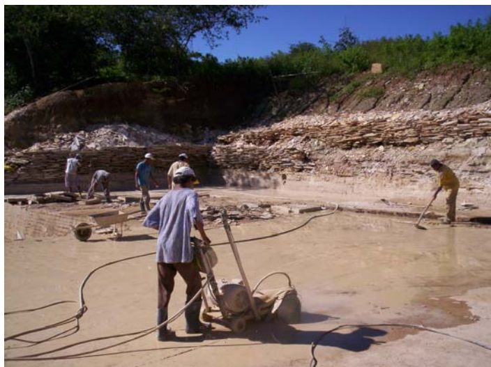
Foto 5.17 – Máquina de corte atualmente ativa em pedreira de Cantagalo, Santana do Cariri, afloramento 5, muito semelhante a da Foto anterior – 5.16b (do autor).
