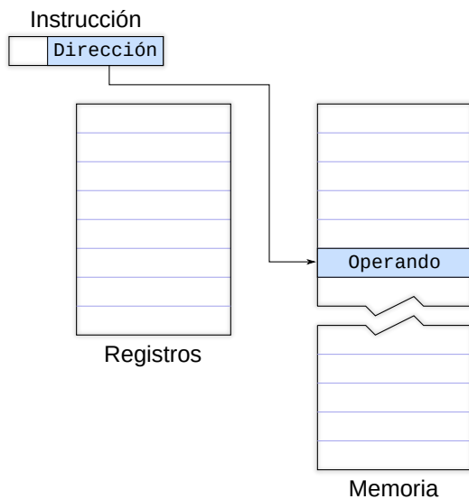
Figura 1.4: Modo de direccionamiento directo a memoria. En este modo, la dirección efectiva del operando es una posición de memoria. En la instrucción se codifica la dirección de memoria en la que se encuentra el operando
