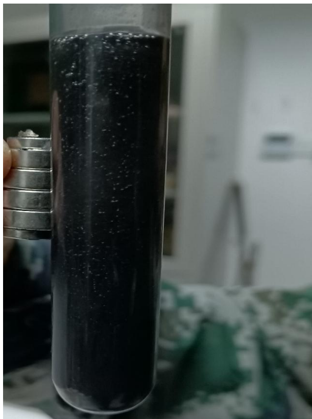
图 8 细铁粉在纯蓖麻油中的实验现象
