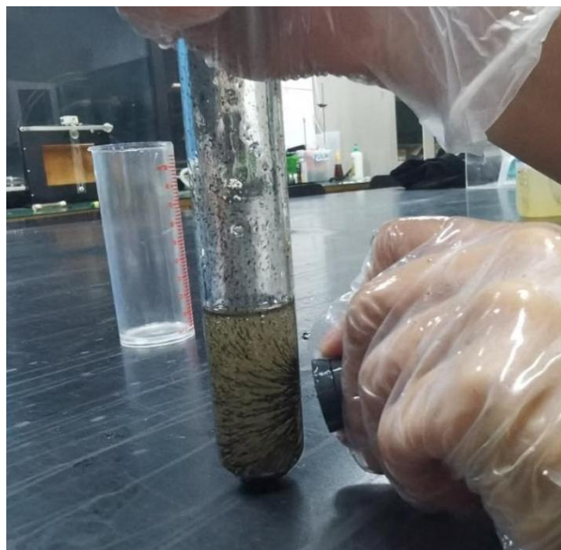
图 9 粗铁粉在纯蓖麻油中的实验现象
