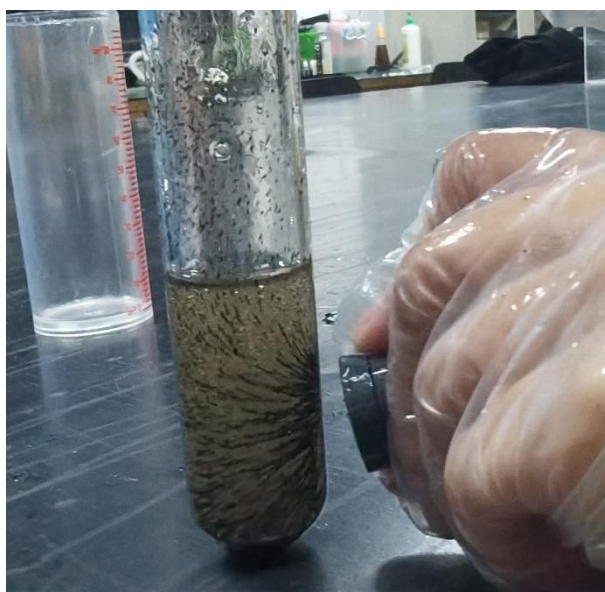
图 5 铁粉在纯蓖麻油中的现象
