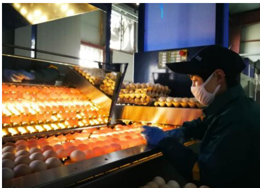
图 1-5 人工肉眼检测微孔裂纹蛋胚
