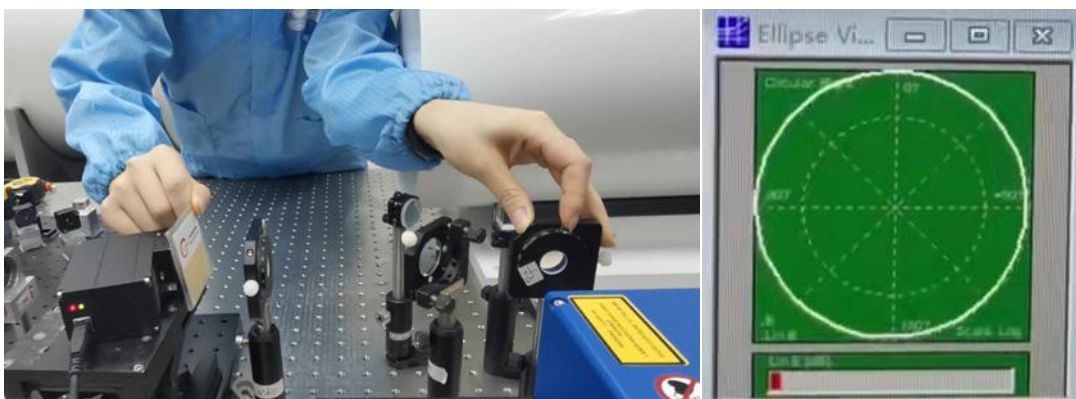
图 17 调节激光偏振态
