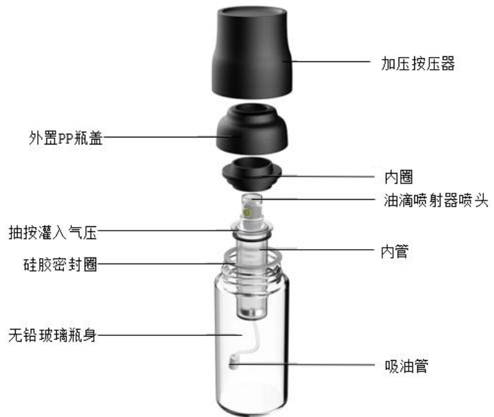
(b) 改进后油滴喷射器分解图
