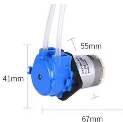
图 2-2 (b) 5W 160r/min 蠕动泵
