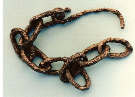
Trozo de cadena alterado por corrosión y luego de la limpieza catódica
