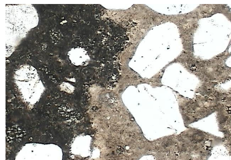
Microfotografía del corte petrográfico, se observa la interfase de ambos morteros
