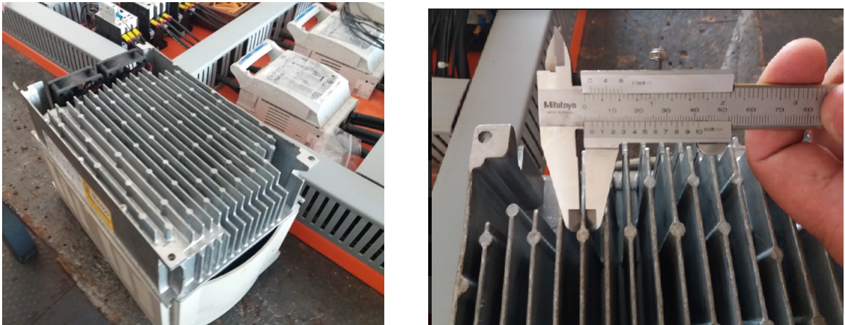
Figura 4.9: Aletas do Inversor(Fonte: [20])
