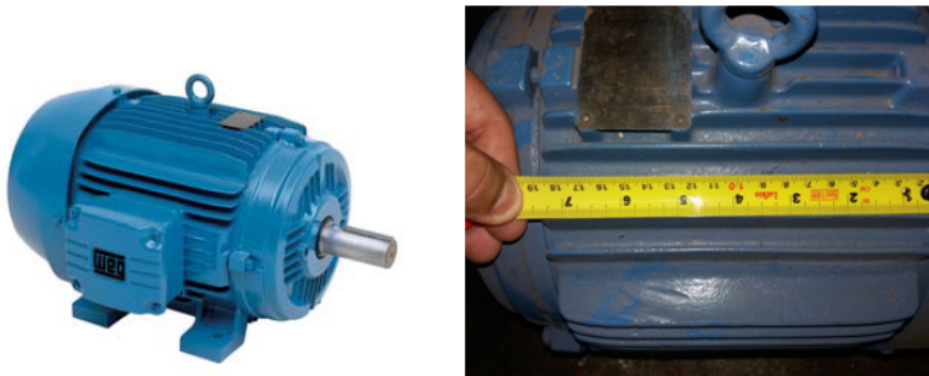
Figura 4.5: Aletas do Motor Elétrico(Fonte: [20])
