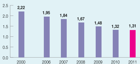
Intensité de consommation d'eau liée au process industriel (en m 3 /tonne de produit)
